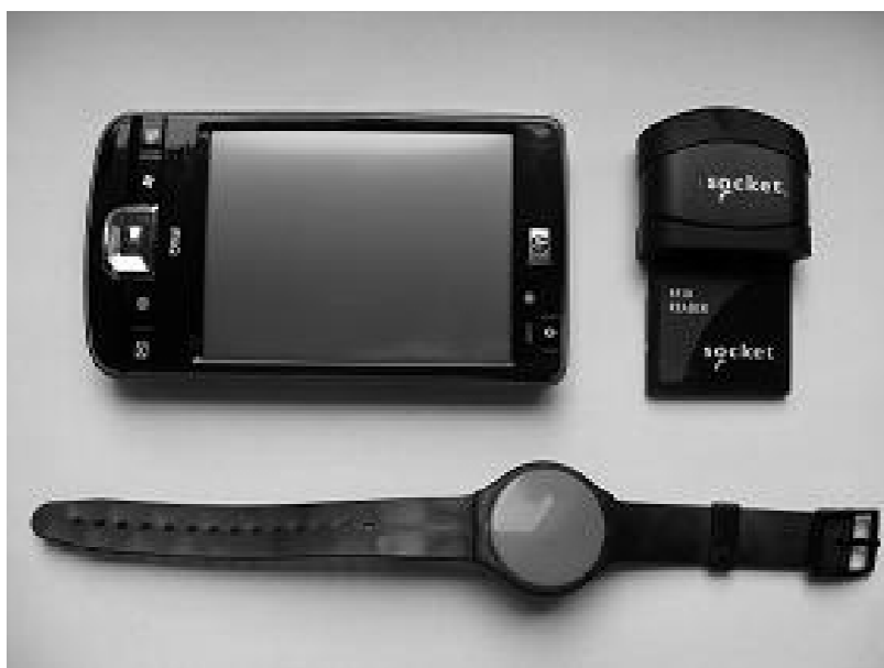
Rys. 2 Konfiguracja sprzętowa RFID zastosowana w badaniach
