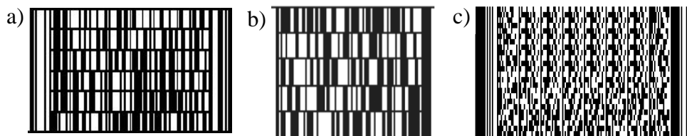
Rys. 1. Przykłady kodów dwuwymiarowych piętrowych. a) Codablock F, b) Code 49, c) PDF417
