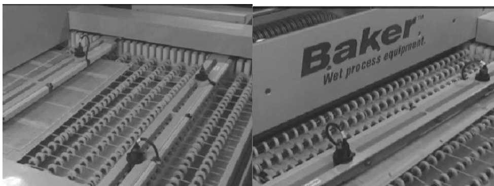
Rys. 3. Przenośnik rolkowy firmy Baker z rolkami w postaci kółek osadzonych na wałkach [2]
