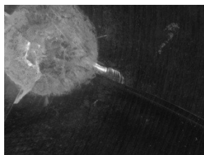
Rys. 14. Efekt wyładowań przy użyciu 80V, szkło popękane, średnica wyładowań około 1,5 mm
