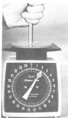
Rys. 2. Pomiar wytrzymałości na ściskanie przy pomocy wagi [3]
