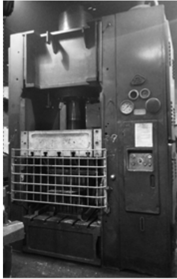
Rys. 2. Prasa hydrauliczna typ PH 400
