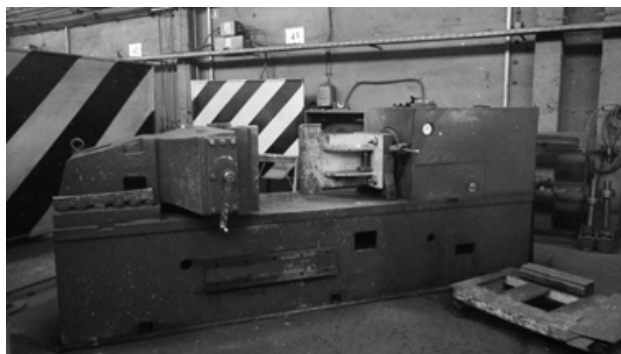
Rys.1. Prasa pozioma „bokserka” typ PYXWH
