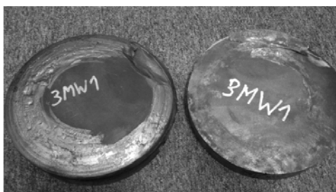
Rys. 4. Fragmenty wału wycięte w miejscu pęknięcia
