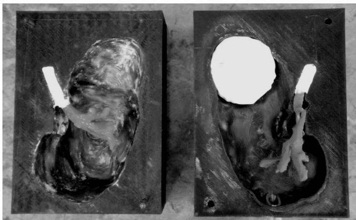
Rys. 4. Widok na wykończone części formy z umieszczonymi elementami składowymi modelu
