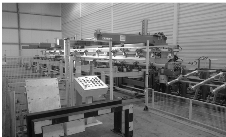
Rys. 1. Linia do formowania profili konstrukcji stalowych firmy STAM
